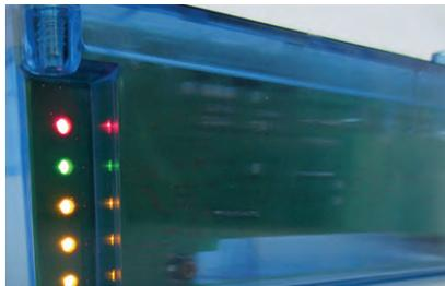
Durch die Überwachung der Aufzugsnutzung stellt der Lift-Status-Transmitter-VOC automatisch Veränderungen in der Gebäudenutzung fest und passt die Lüftung eigenständig an den Bedarf an. Es handelt sich um eine geschlossene Einheit, die über einen drahtlosen Funk-Sender mit der Zentraleinheit oder mit dem abgesetzten Funk-Empfänger kommuniziert.
