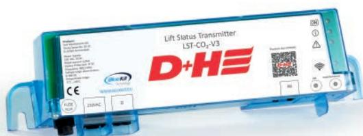
Durch die Überwachung der Aufzugsnutzung stellt der Lift Status Transmitter-CO<sub>2</sub>-V3 (LST-CO<sub>2</sub>-V3) automatisch Veränderungen der Luftqualität fest und gibt eigenständig ein Lüftungssignal an die Zentrale. Es handelt sich um eine geschlossene Einheit, die über einen drahtlosen Funk-Sender mit der Zentraleinheit oder dem abgesetzten Funk-Empfänger kommuniziert.
